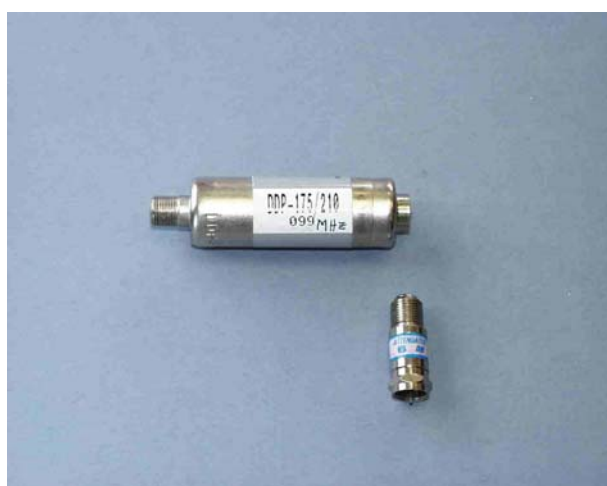
Figura 15 - Em cima filtro supressor de banda(175 a 210 MHz); em baixo filtro atenuador de 6dB
