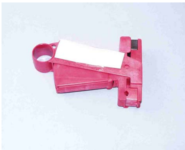
Figura 1 - Descarnador para cabos (RG59, RG6, RG7 e RG11)
