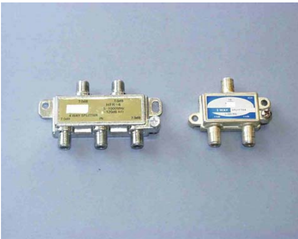
Figura 10 - À esquerda TAP terminal de 4 vias; à direita TAP terminal de 2 vias
